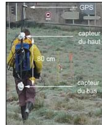
Magnétomètre GSM19 en configuration de gradiomètre
